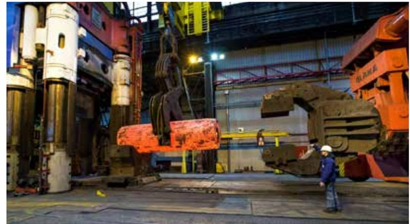
Opération de forgeage Framatome Creusot Forge
